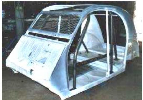
L'assemblage caisse/châssis ne pose pas de problème particulier, les fixations devant toutefois pouvoir résister aux chocs ! Les portières arrière et la capote sont retirées, les vitres sont généralement remplacées par un grillage d'acier. Des sangles maintiennent fermés le capot et les portières avant. Le découpage des ailes n'est pas obligatoire, mais évite l'accumulation de boue par mauvais temps et donc l'excès de poids.
