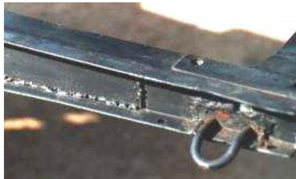
Vient ensuite le montage des trains avant et arrière, là encore pour les mêmes raisons de solidité on préférera les pièces d'Ami 8, d'Acadiane, éventuellement de 2CV 6 pour le train arrière. Les biellettes de direction, soumises à des chocs constants et quelques fois violents, doivent être renforcées, ainsi que la barre de direction généralement insérée dans un tube en acier.
